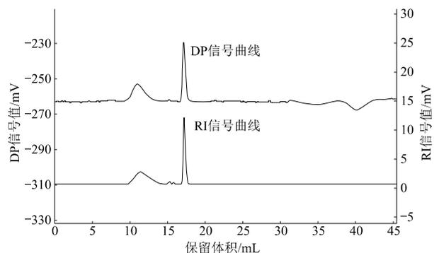
图2 聚羧酸盐分散剂的 GPC 谱图
