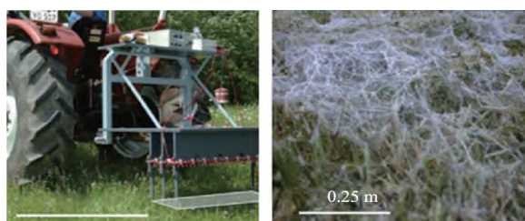
A 配备静电纺丝装置的大型农机直接在农田中喷施负载信息素的纤维 [40]
