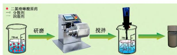
图4 二氯喹啉酸纳米悬浮剂的制备示意图<sup>[50]</sup>
